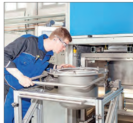
Abb. 2: Mit der elektrohydraulischen Zerkleinerungsanlage können Verbundmaterialien selektiv aufgetrennt werden (Foto: Impulstec)
