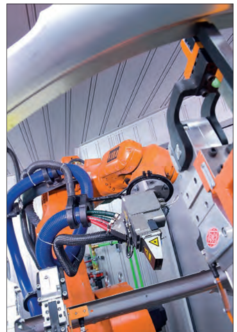
Abb. 1: cleanLASER bei der Schweißvorbehandlung im Karosseriebau (Foto: AUDIAG)
